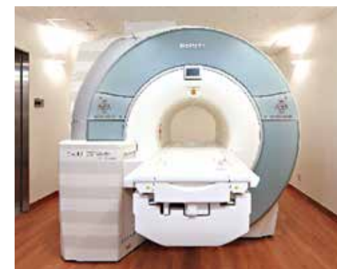
MRI装置 MAGNETOM Verio3T (シーメンス) 磁場が3.0のテスラの装置です。磁力が強いため、1.0テスラと比較し時間短縮が可能となり、より鮮鋭度の高い画像が撮影可能になりました。特に脳の血管は末梢まで描出が可能です。
